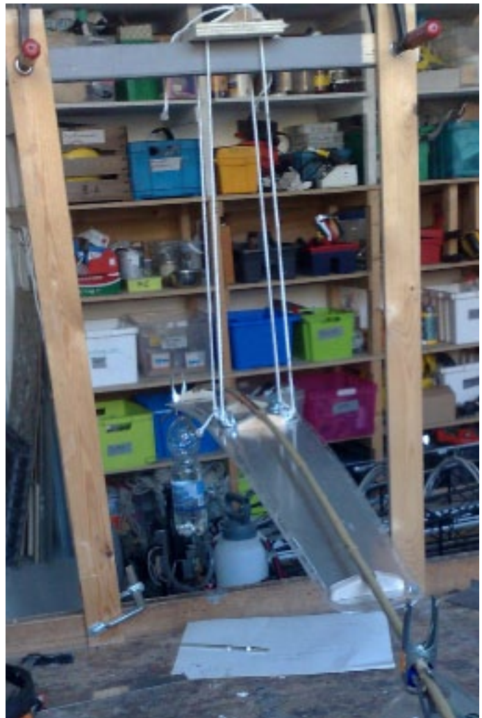
Buiten de ophangpunten wordt de constructie belast waardoor de ligger buigt.
