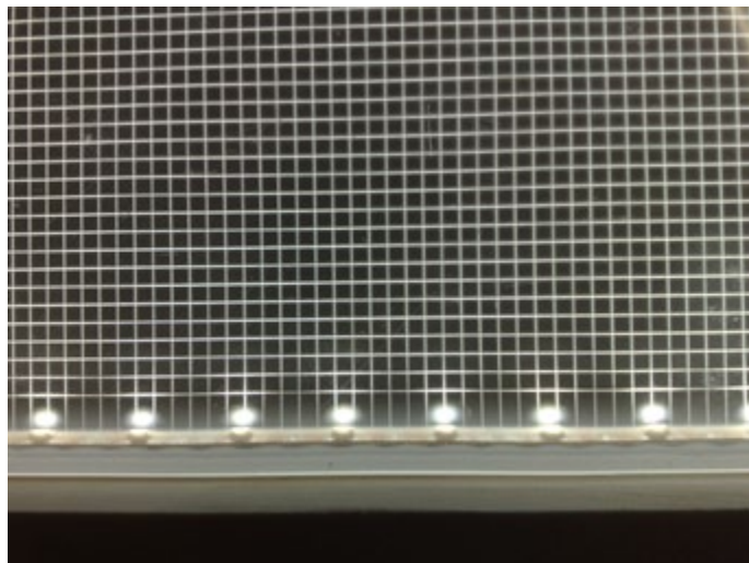
voorbeeld van een goed werkende lichtplaat: egaal licht, praktisch maakbaar, hoge lichtstroom (wit licht 20W/m) (Pyrasied Leeuwarden )
