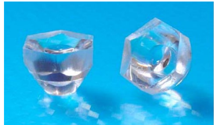
Collimator lens van polycarbonaat, beperkt de hoek tot 6 graden, optische efficiency 85%
